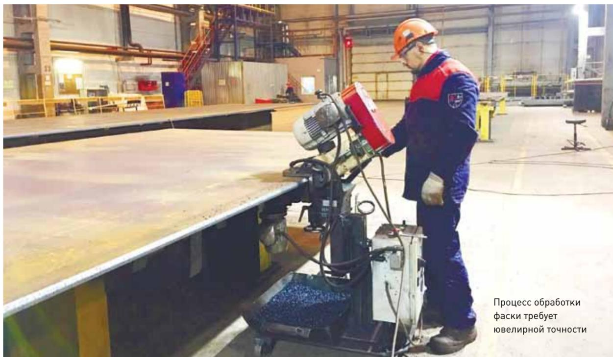
Процесс обработки фаски требует ювелирной точности
