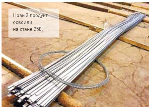
– Полоса очень тонкая, поэтому при сбросе с приемного рольганга на рихтовочные плиты происходила деформация раската. Также существовала проблема в транспортировке продукции по холодильнику металла, – говорит начальник цеха № 2 СПП Владимир Валин. – Мы разработали мероприятия, которые позволят решить эти вопросы и предупредить возникновение новых.
